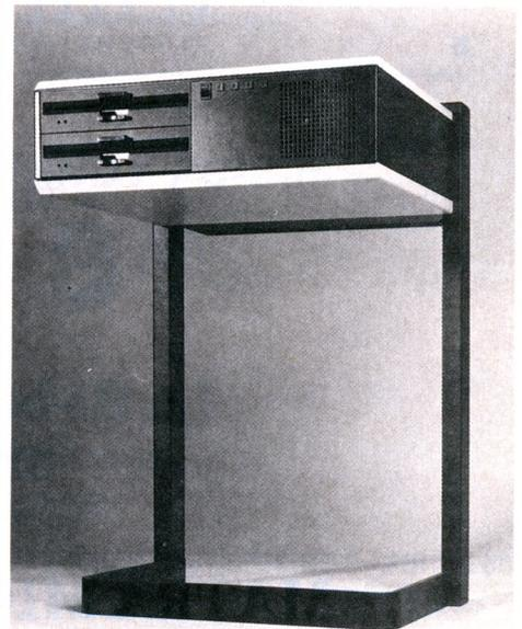
geables : 24 entrées-sorties programmables, possibilité d'un processeur mathématique (compatible avec la norme IEEE). Ses disquettes sont des huit pouces de deux fois un million d'octets et le disque dur (Winchester) de 8,4 millions d'octets. Il peut recevoir pas moins de trois systèmes d'exploitation (CP/M 86, MP/M 86 et MS-DOS). Son prix : 49 300 F H.T. ■
